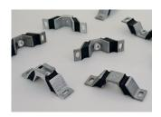
**SILENZIO Deckenhänger SX**Element für die entkoppelte Befestigung mit mechanischer Brandsicherung von Laufschienen, Schiebetürschienen und Leitungen an Decken. Metallteile aus Aluminium, Entkopplung aus Naturkautschuk Härte 50° Shore A.
